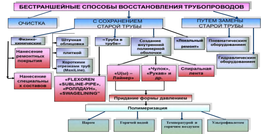
Рис.3. Классификация бестраншейных способов восстановления коллекторов
