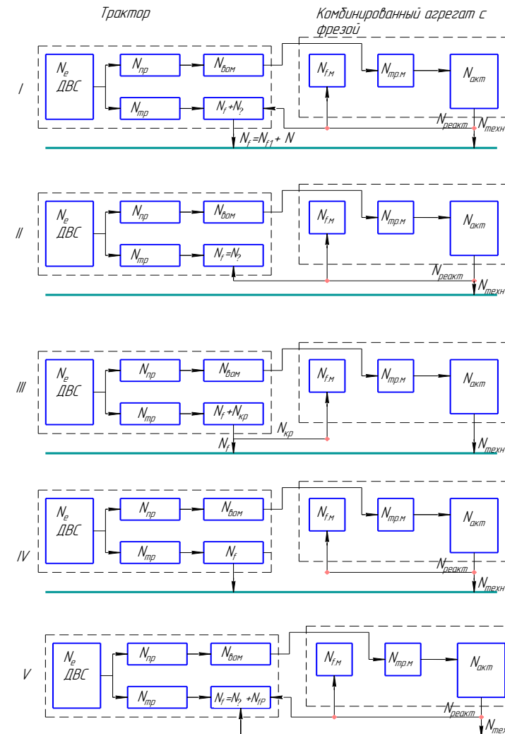
Рис. 2. Схема распределения мощности в комбинированном агрегате с почвенной фрезой
